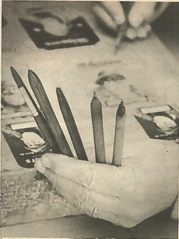
— Nålene var litografens viktigste verktøy. Vi måtte slipe dem til selv, og ingen litograf hadde like nåler. Derfor kunne man ikke låne kollegenes arbeidsredskap, og dersom en nål ble borte var hundre og ett ute, forteller Bjørn Bøthner.
